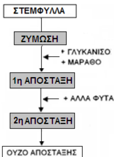
Σχήμα 26.2 : Διάγραμμα παρασκευής του ούζου μονής και διπλής απόσταξης
