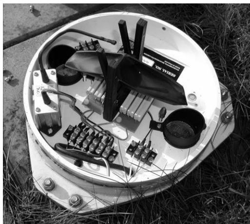
Σχήμα 12. Το εσωτερικό ενός βροχομέτρου ανατρεπόμενου ζυγού.
